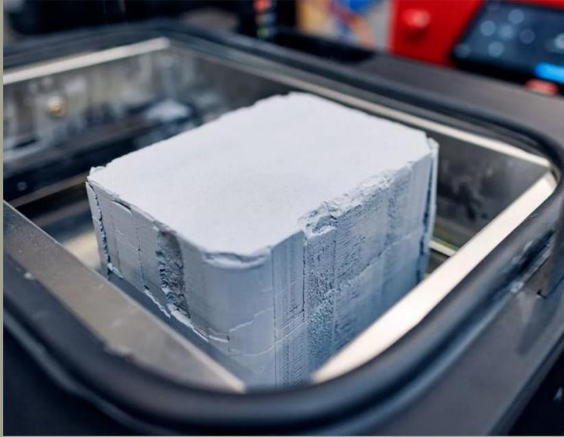
تليد الليزر الانتقائي (SLS): يتم دمج المواد المسحوقة مثل النايلون أو المعدن معًا بواسطة الليزر، مما يؤدي إلى إنتاج أجزاء قوية ومقاومة للحرارة. تستخدم للنماذج الأولية الوظيفية الدفعات الأولية الصغيرة.
