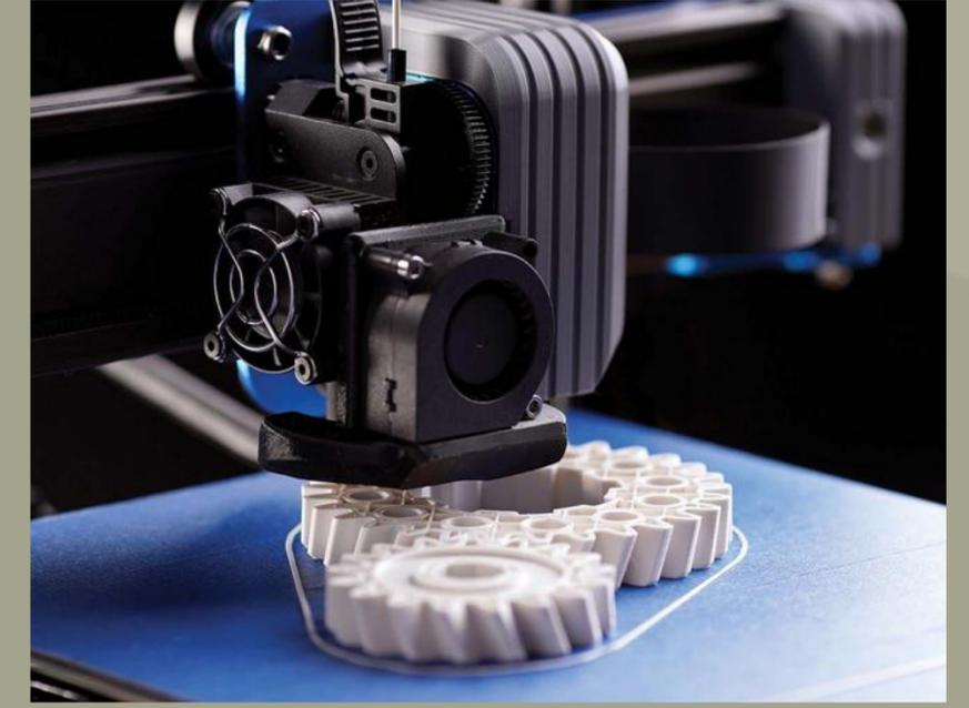
النمذجة بالرواسب المصهورة (FDM): يتم بثق الخيوط البلاستيكية المنصهرة من خلال فوهة لإنشاء طبقات. هذه التقنية بسيطة ومتعددة الاستخدامات وتستخدم على نطاق واسع في النماذج الأولية ومشاريع الهوايات.
